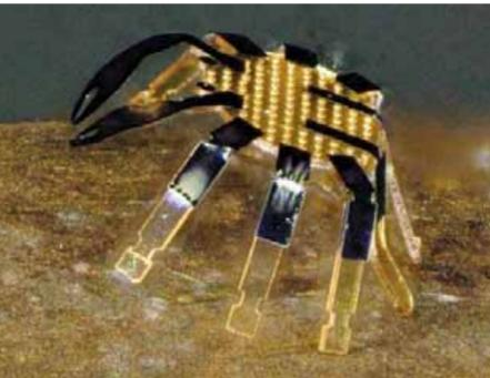
ينحنى ويحرك ويمشي ويدور ويفرق. واستغرق العلماء عاماً ونصف لصنع الروبوت، بداية من تشكيل هيكل مصلح ثم ربطهم ببعضهم البعض على ركيزة مطاطية مشدودة قليلاً على شكل سرطان بحر ثلاثي الأبعاد. ولا يتم تشغيل الروبوت بواسطة أجهزة معقدة أو طاقة كهربائية أو هيدروليكية، وبدلاً من ذلك يعتمد على مرونة جسمه، حيث استخدم الفريق سبيكة معدنية مطيعة بالزجاج تحفظت بذاكرة للشكل عند تسخينها بالليزر.
